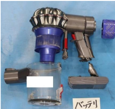
写真 2-1 焼損したコードレス掃除機の状況
