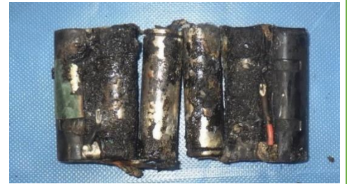
写真 2-3 焼損した非純正品バッテリーセルの状況
