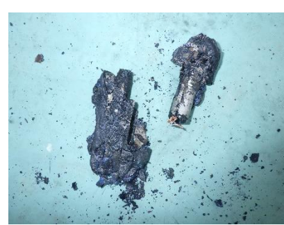
写真 1-3 潰れて燃えた充電式電池
