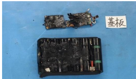
写真 2-2 焼損した非純正品バッテリーの状況
