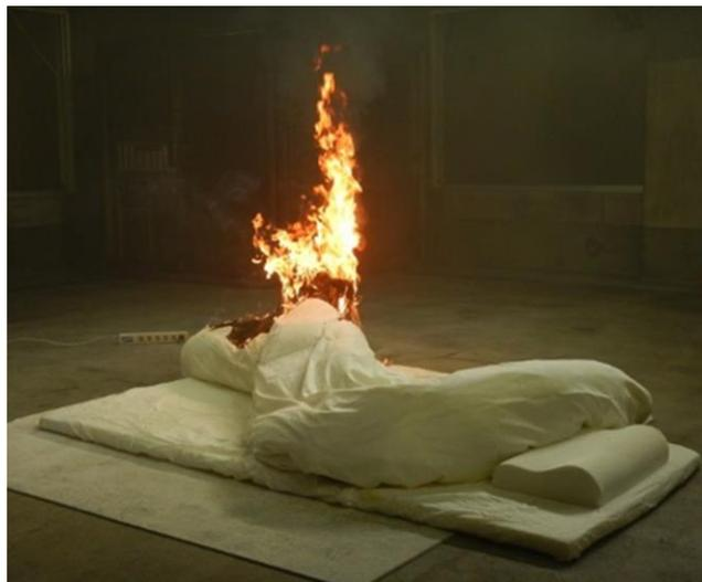
写真1 電気ストーブに掛布団が接触し出火した様子（実験写真）
