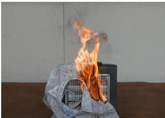
写真2 電気ストーブの上に洗濯物が落下し出火した様子（実験写真）
