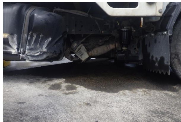
燃料タンクの破損状況
