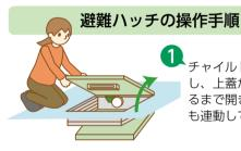
・チャイルドロックを外 し、上蓋がロックされ るまで開きます。下蓋 も連動して開きます。
