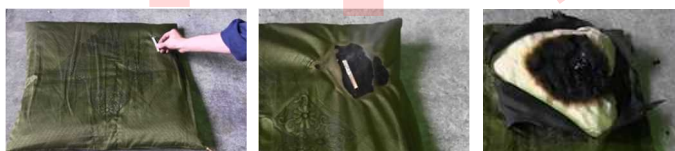
たばこを座布団に接触 35分後 焼損状況
