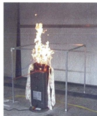
図5-14 サンプルB (シーズヒータ) パジャマ正面 0cm 写真
