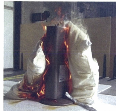
図5-11 サンプルB (シーズヒータ) 布団巻き付け写真
