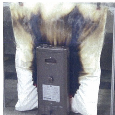
図5-17 サンプルB (シーズヒータ) 防災カバーをつけた布団写真
