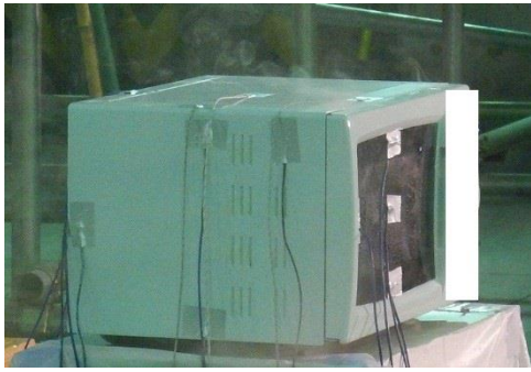
写真2 熱電対設定状況（正面、上面、側面）
