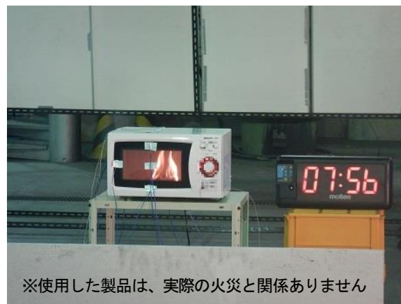
写真3 冷凍食品の燃焼状況
