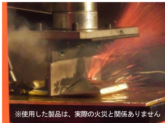
写真1 リチウムイオン蓄電池の圧壊状況
