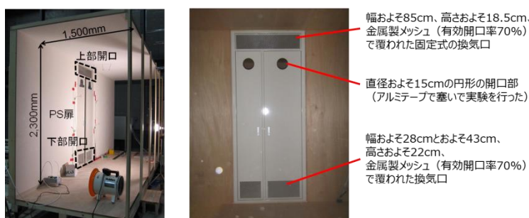
図 2.2.3-2 パイプシャフト設置状況
