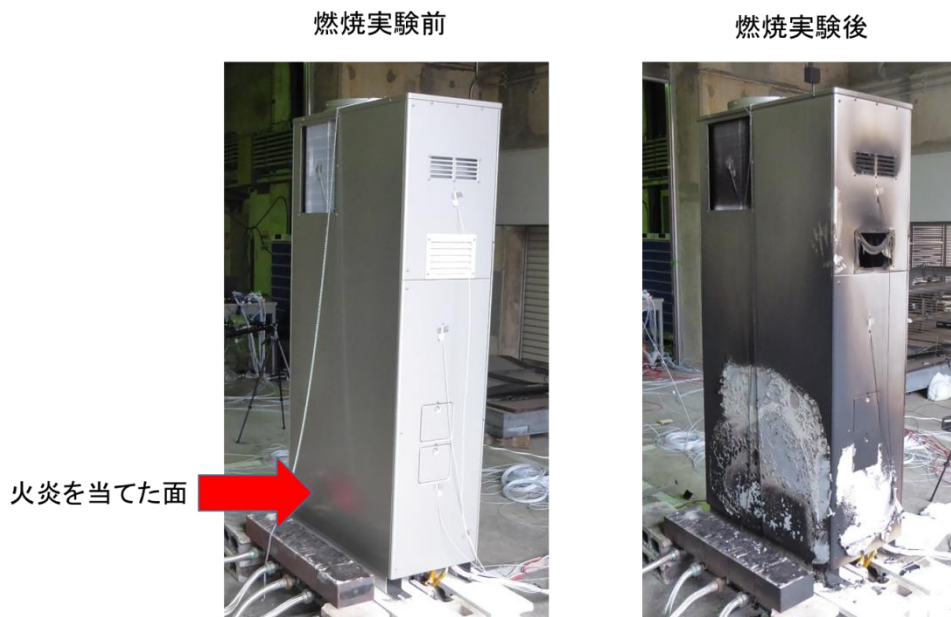
図 5.3-2 目視観測（実験前後の外観）
