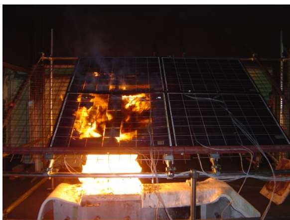
写真5-15 Test-9_A1 5分時の状況
