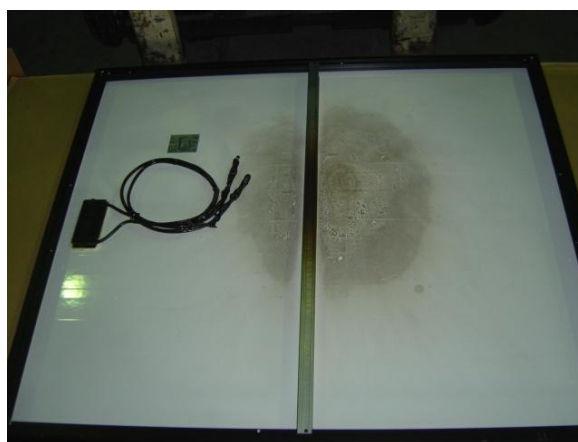
写真5-6 Test-1_A1 実験後裏面の状況
