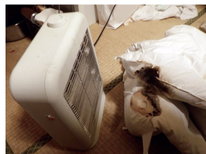
電気ストーブに布団が接触し焼損した状況
